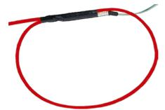
Para prevenir la posibilidad de que el extremo del cordón detonante quede cortado al iniciarse el detonador, debe hacerse un lazo como indica el dibujo uniéndose fuertemente detonador y cordón fuertemente usando cinta aislante adhesiva.
